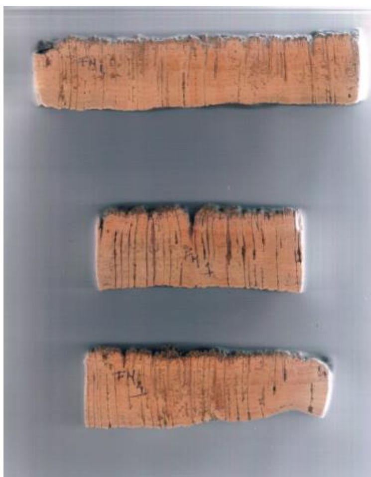
Figure 17 : Les éprouvettes utilisées pour les mesures de l'épaisseur sous croûte du liège.
