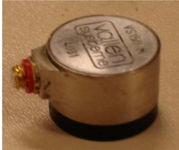
**Figure II.18** : Capteurs VS 150-M.
