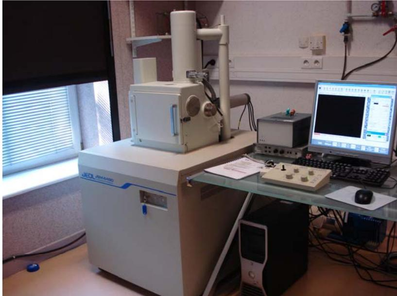
**Figure II.25** : Microscopie électronique à balayage 6490W.
