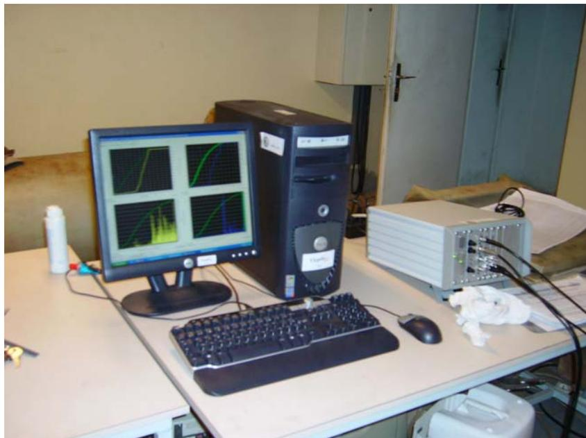
**Figure II.17** : Montage pour l'émission acoustique
