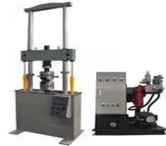
Figure II.10: machine d'essai de fatigue
