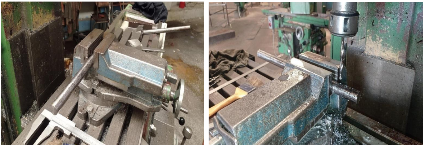
Figure III.26: opération de perçage
