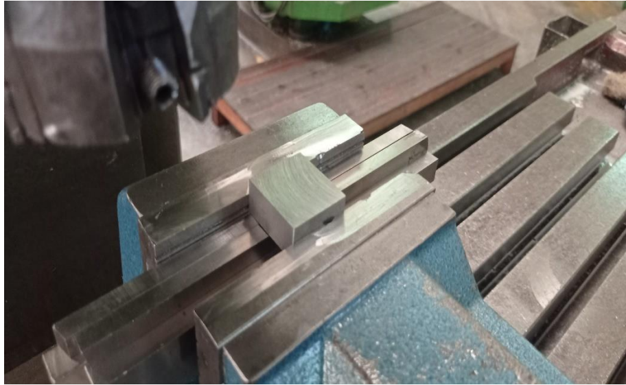
Figure III.25 : opération de surfacage
