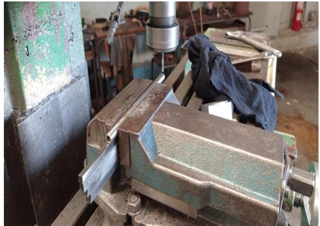
Figure III.28: opération de perçage
