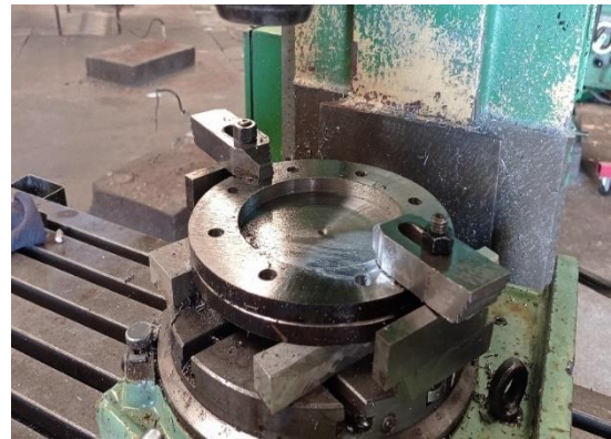
Figure III.24 : opération de perçage avec l'utilisation d'un plateau diviseur
