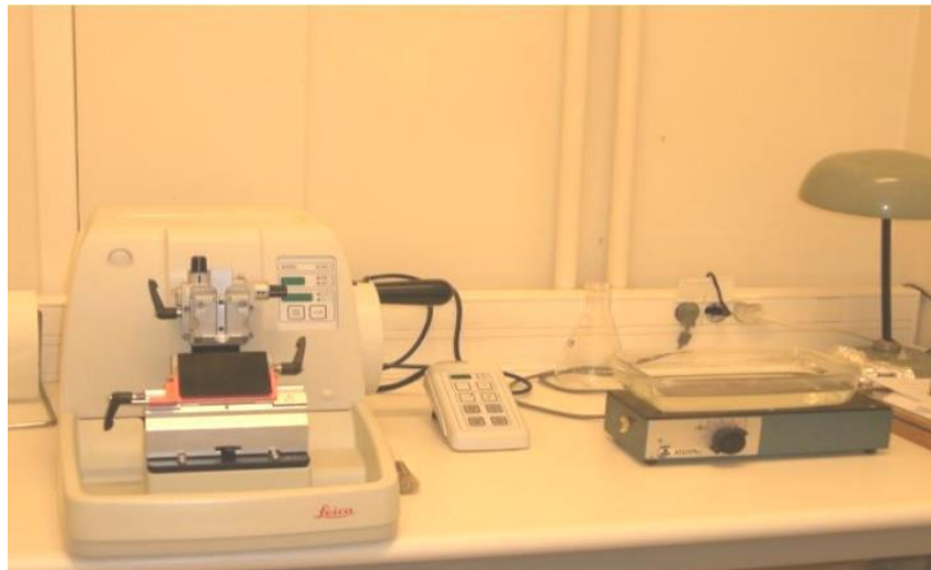
Figure 27: Dispositif permettant de faire des coupes : microtome à gauche et bain Marie à droite
