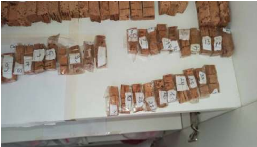
Figure 18 : les éprouvettes utilisées pour déterminer la densité du liège.
