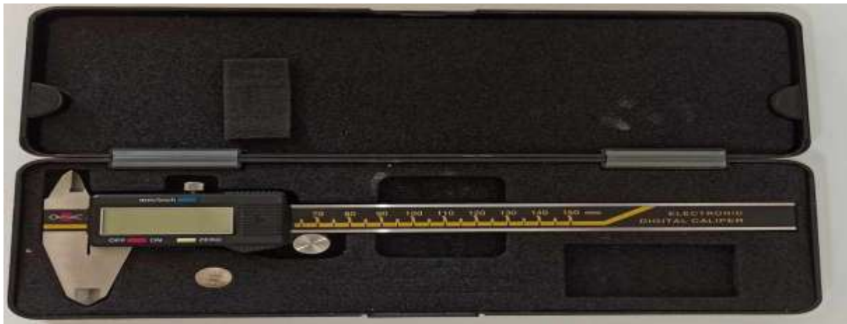
Figure 15 : Pied à coulisse avec lequel l'épaisseur a été mesurée. Originelle (2023).
