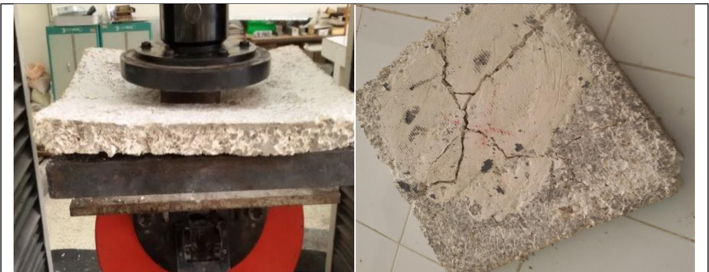
Panneau témoin : Rupture du panneau par poinçonnement
