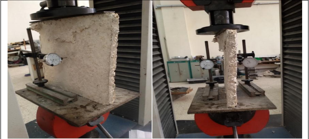
Panneau témoin sans renforcement
