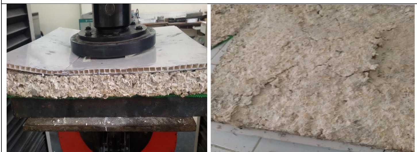
Panneau + renforts Tissu/Polymère (coté Polymère) : Rupture du panneau par poinçonnement
