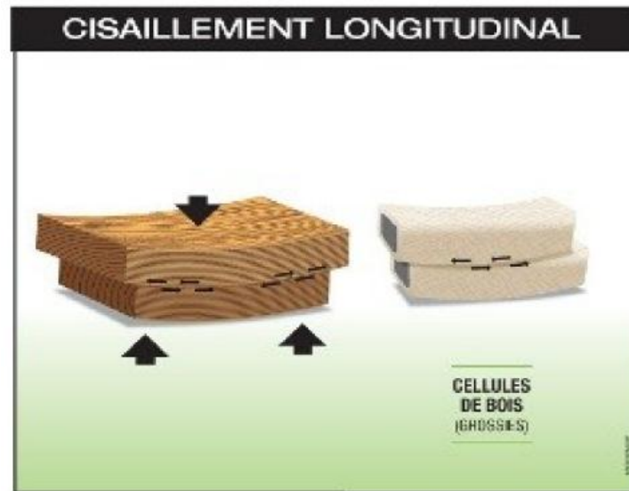
Figure I.14. Comportement du bois en cisaillement. [25]
