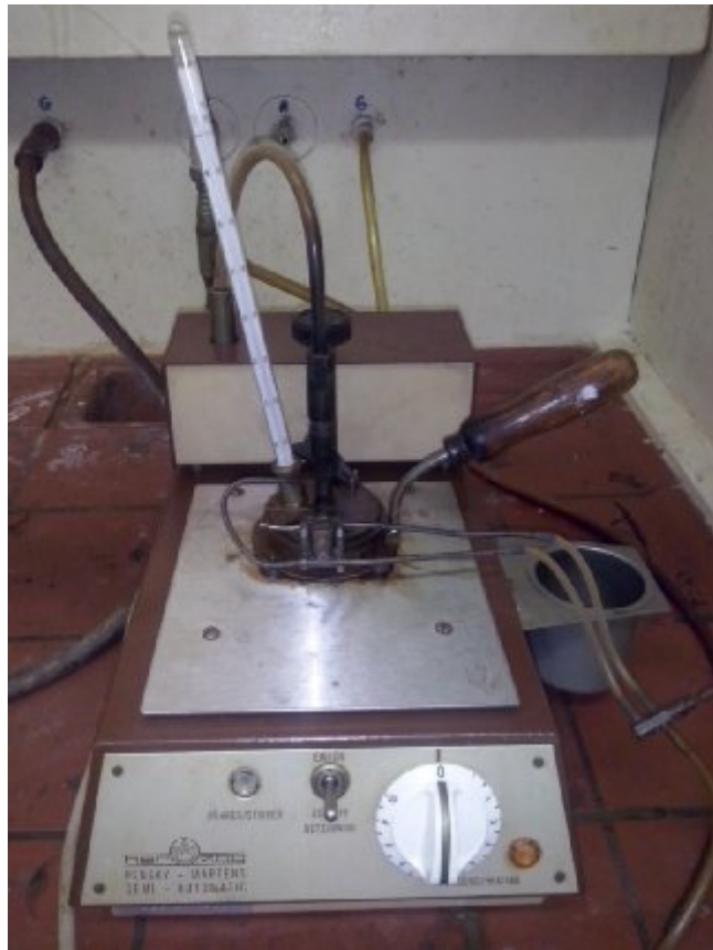
Figure IV.9. Dispositif expérimental du point d'éclair
