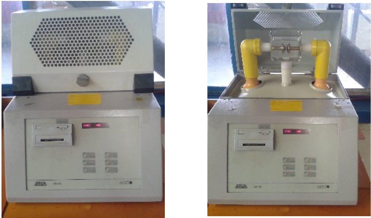
Figure IV.1. Dispositif d'essai de la tension de claquage.
