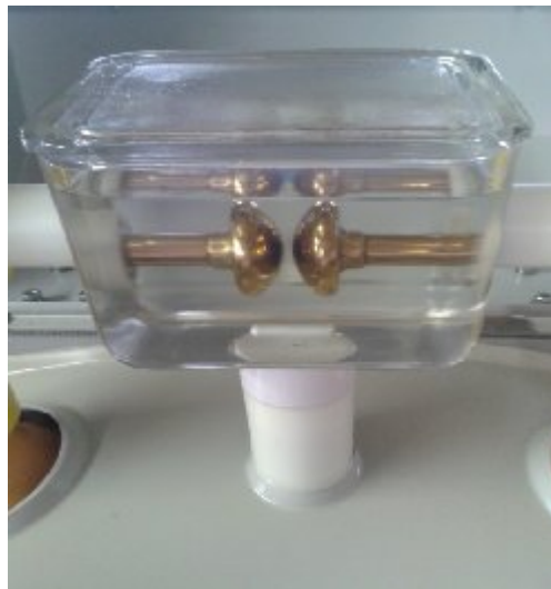
Figure IV.2. Cellule d'essai de la tension de claquage.
