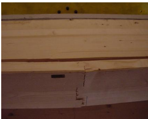
Fig III-6 : Rupture de la poutre en bois
