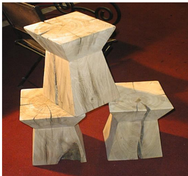
Fig I-20 : Fissures radiales de retrait
