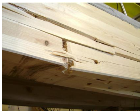
Fig III-6 : Rupture de la poutre en bois
