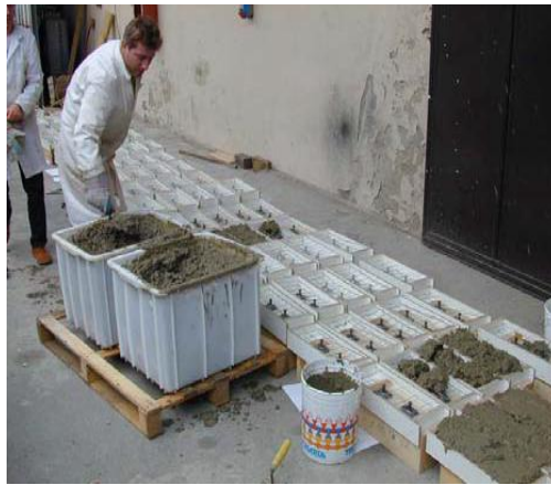
Fig III-37 : Pose du béton.
