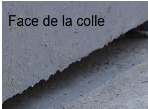
Fig III-8 : Rupture adhésive de l'interface colle-béton
