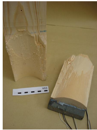
b) surface de rupture au niveau du bois
