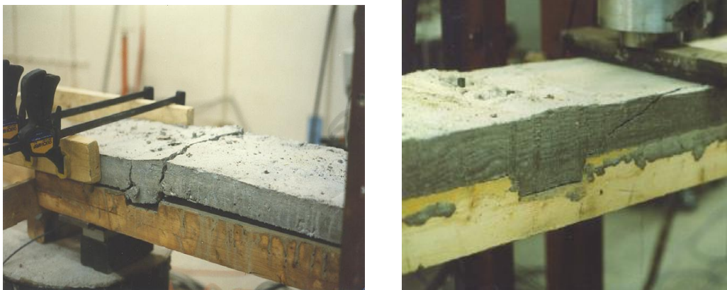
Fig III-24 : Rupture de la couche de béton
