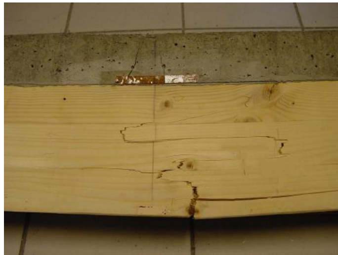
Fig III- 42: Rupture en traction du bois et du béton
