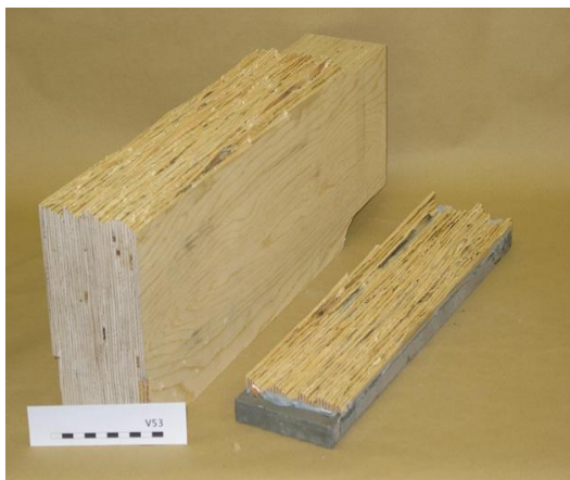
c) Surface de rupture près de bond-line
