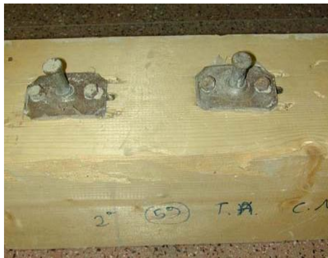
Fig III-39 : Fluage des connecteurs à la fin de l'essai
