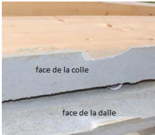
Fig III-8 : Rupture adhésive de l'interface colle-béton
