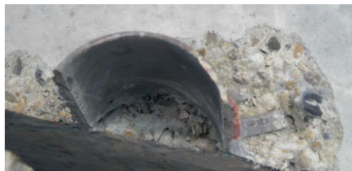
Fig III-33 : Le connecteur « shear crown » et son mode de rupture
