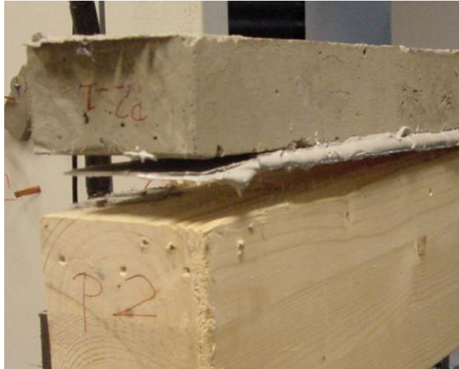
Fig. III-4 : Rupture par arrachement du bois
