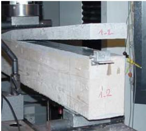
(a) Décollement au cours d'essai en flexion
