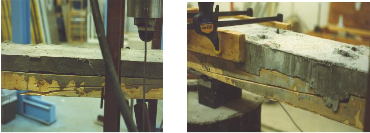
Fig III-25 : Rupture de la poutre en bois
