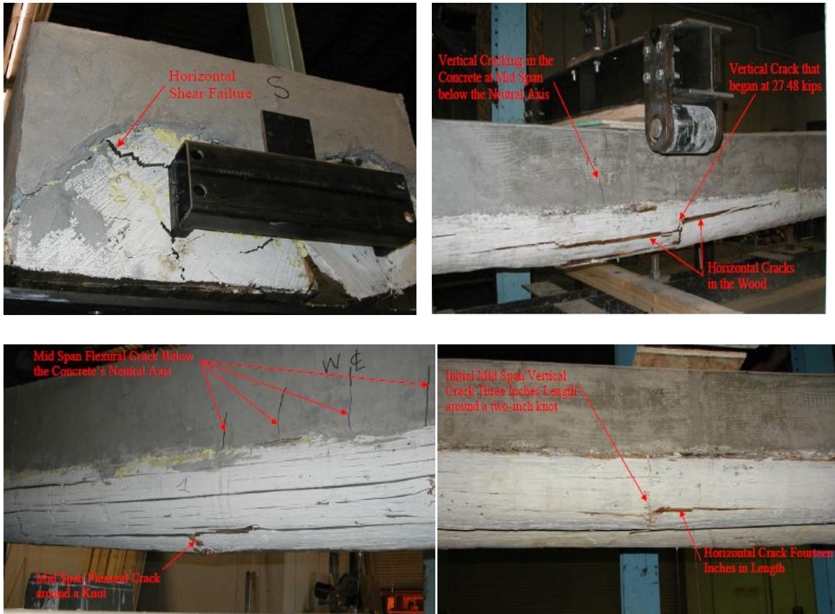
Fig III-30 : Fissuration dans toutes les directions du bois et béton.
