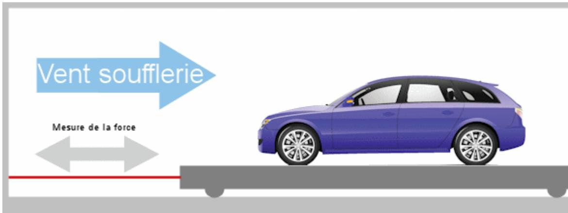
**Figure III.8 :** Schéma illustrant la méthode de mesure de la force de traînée dans une soufflerie.
