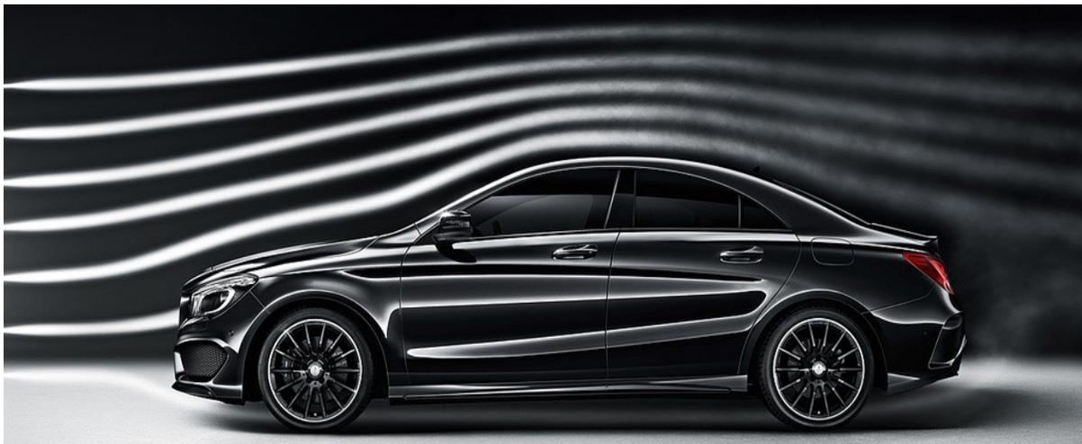
*Figure III.1 : Essais dans une soufflerie, les lignes de courants sont visibles grâce à la fumée opaque.*
