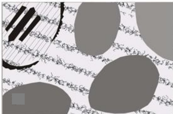
Fig III.5 : Schéma montre le remplacement du feldspath par la kaolinite.
