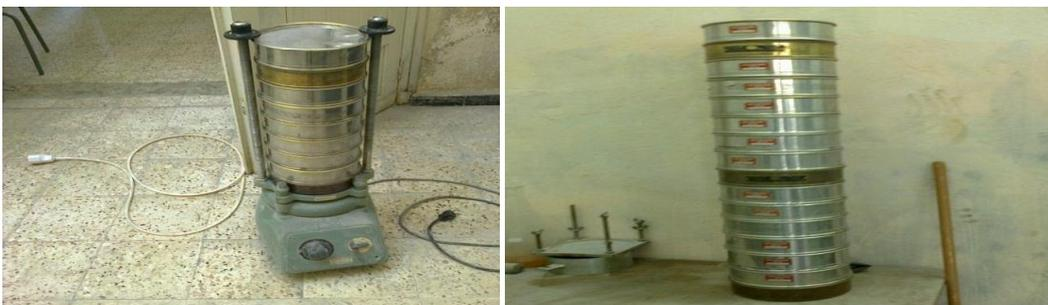
**Figure I.4 : Analyse granulométrique par tamisage.**
