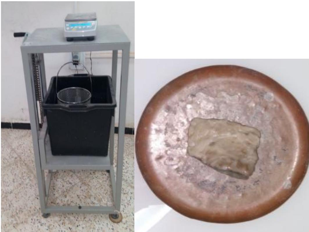
**Figure I.8 : Principe et matériels de la pesée hydrostatique.**
