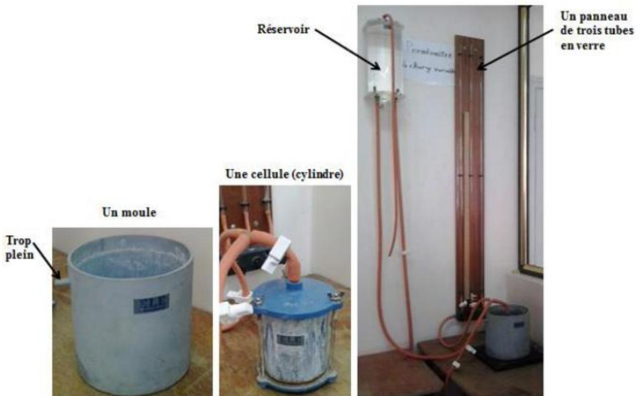
Figure III.7 : Perméamètre à charge variable.
