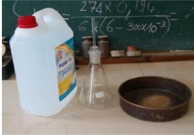
**Figure I.9 : Matériel d'essai au pycnomètre**
