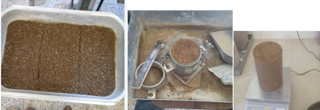
**Figure II.3 : Matériel de confection des éprouvettes de l'essai Proctor normal.**
