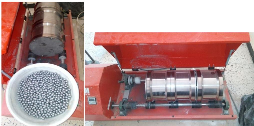
**Figure III.2 : Machine d'essai Micro-Deval**
