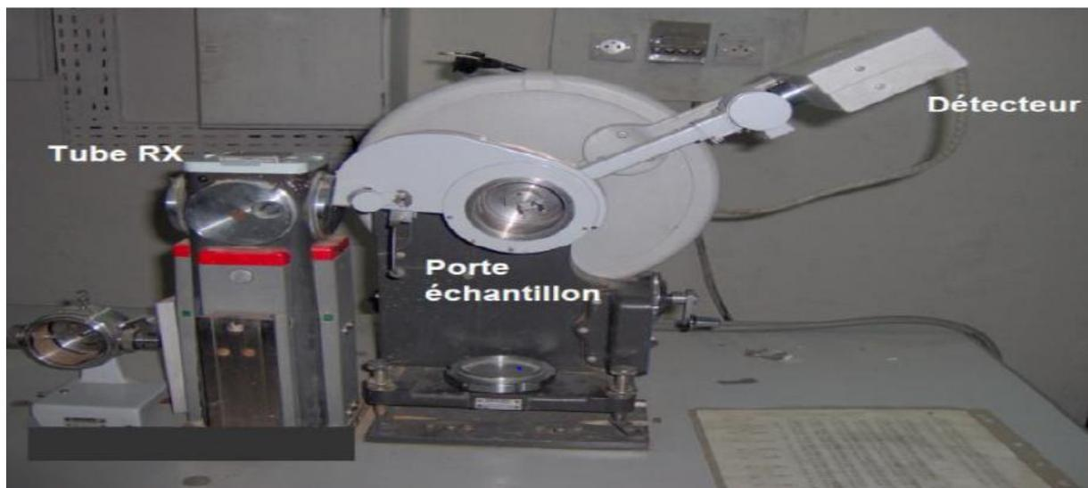
**Figure I.1 : Schéma d'un diffractomètre.**
