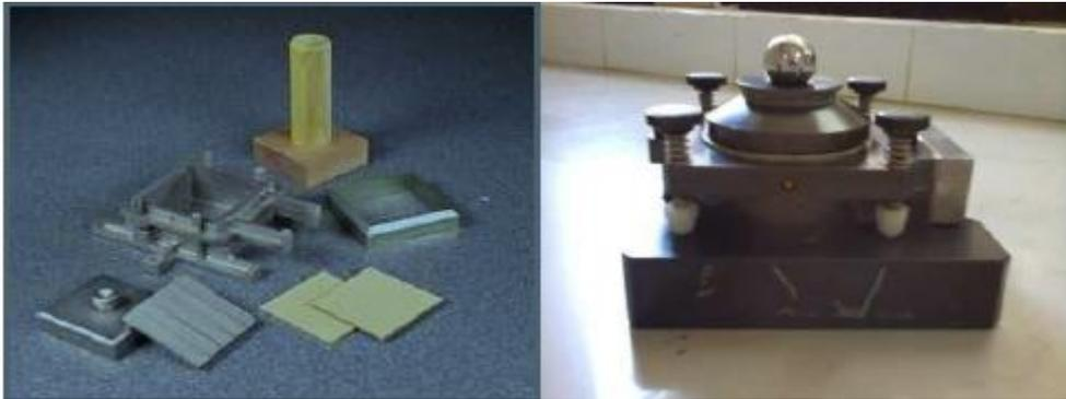
**Figure II.9 : Les boîtes de cisaillement.**
