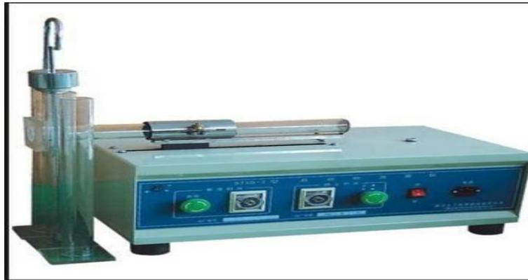
Figure I.6 : appareillage de l'équivalent de sable
