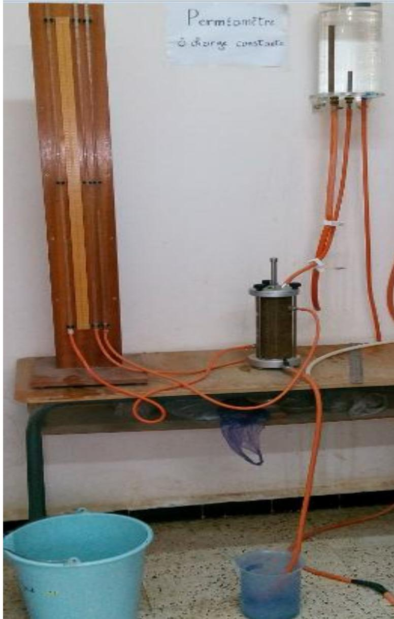
**Figure III.4 : l'essai de perméabilité a charge constante**
