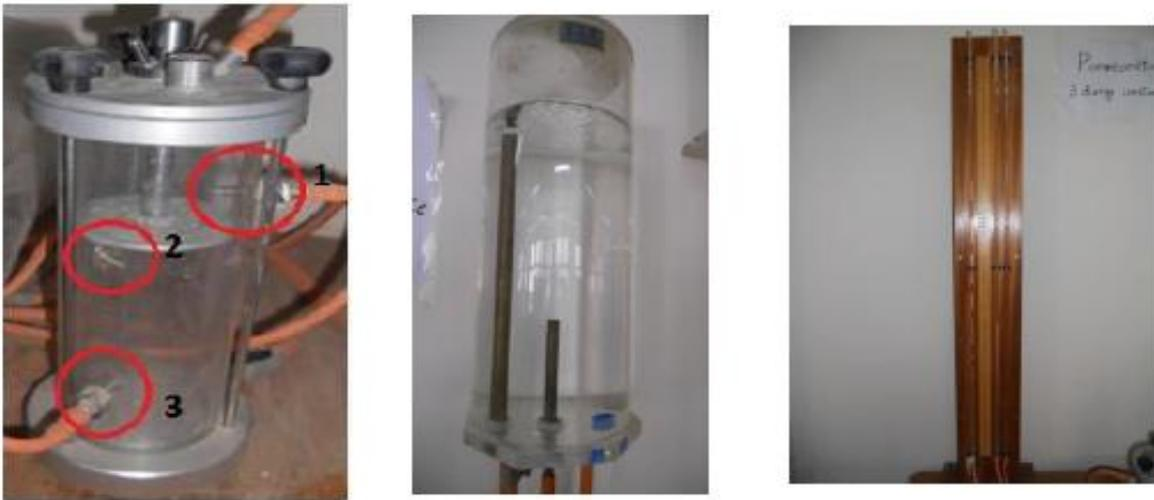
**Figure.III.3 : Perméamètre à charge constante**
