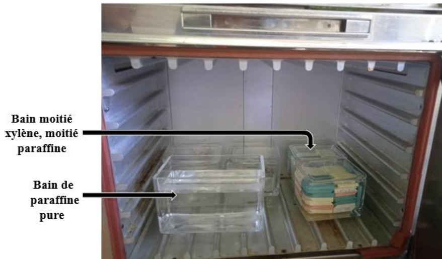
Figure 40 : Photographie d'une étuve de paraffinage (originale, 2023).
