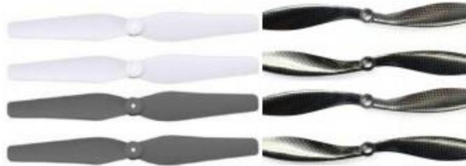
*Figure IV. 2 : hélices de quadrirotor*
