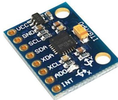
*Figure IV. 5 capteur gyroscopique*
