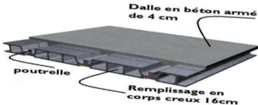
Figure III.2.3 : Coupe verticale du plancher corps creux
