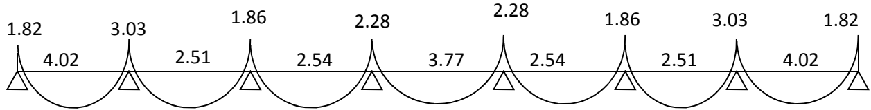
Diagramme des moments fléchissant à L'ELS
