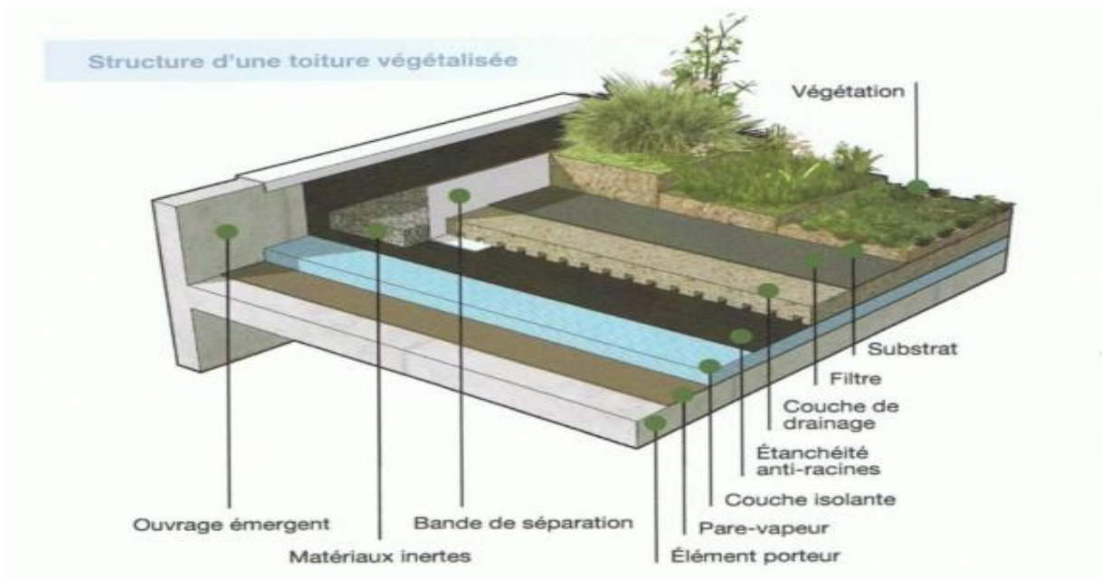
Figure V.3.5 : structure d'une toiture végétalisée
