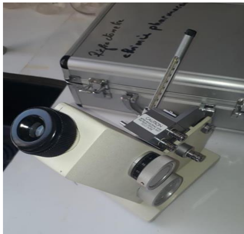
Figure 12 : Réfractomètre utilisé pour la mesure de l'indice de réfraction et le degré de Brix.
