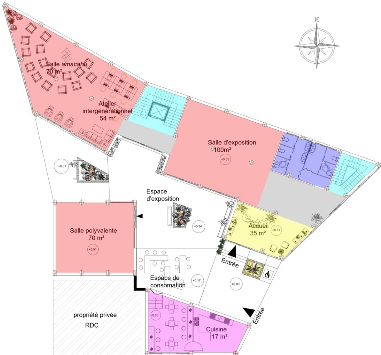
**Figure 52** : Plan rez-de-chaussée, échelle 1/200. **Source** : Auteurs
