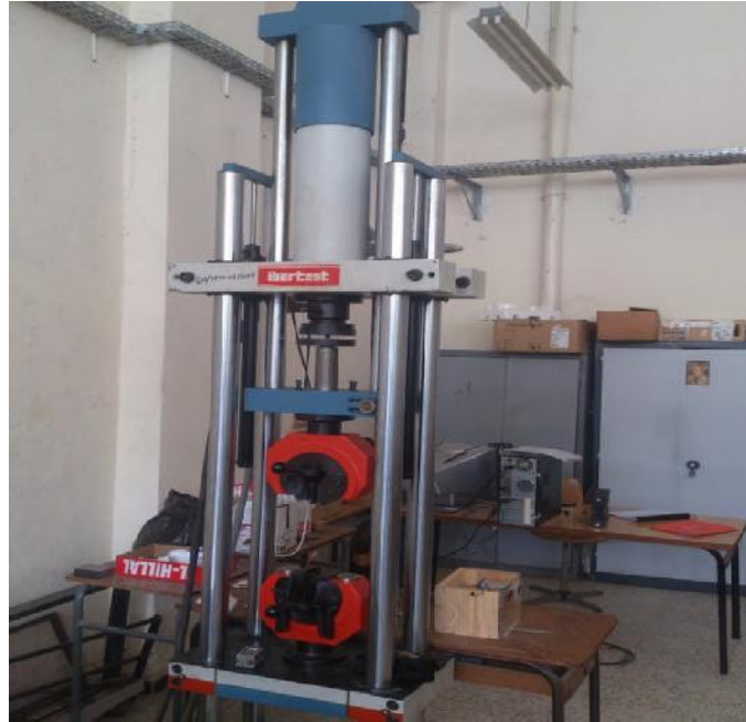
Figure 31: Dispositif de l'essai de compression uniaxiale.
