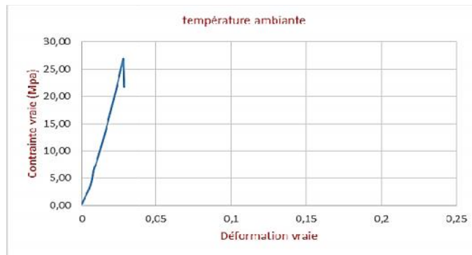
Figure.41: Comportement du PC en traction à température ambiante
