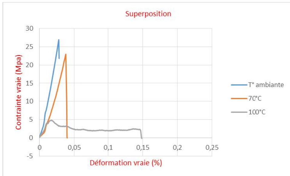
Figure 44: Comportement du PC en traction pour différentes températures.
