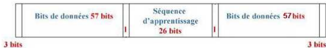
Figure 1.11. Structure d'un burst
