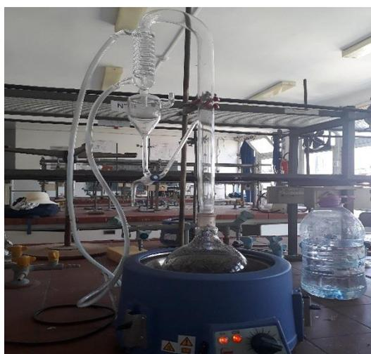
**Figure 29** : Appareil de type Clevenger (Laboratoire de chimie, 2019).
