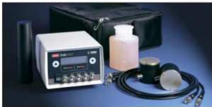
**Figure IV.7 : Appareil d'auscultation sonore**
