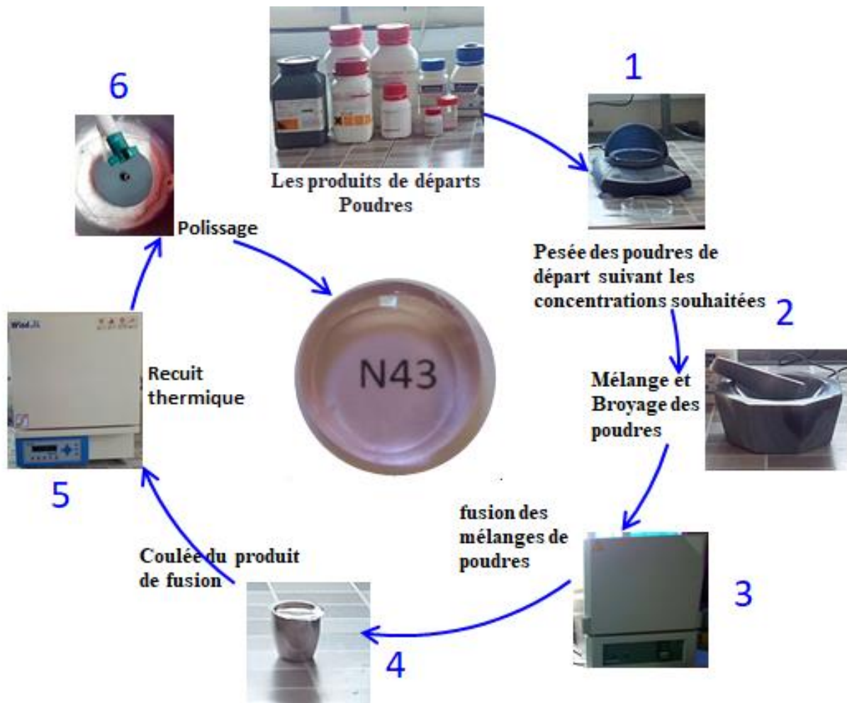
Figure 3.1 : Schéma descriptif des étapes de synthèse des verres
