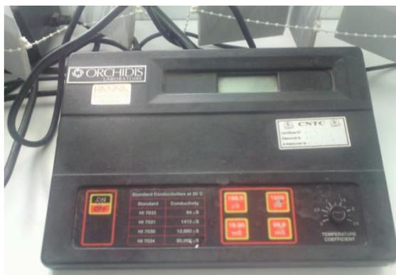
Figure 15 : Conductimètre.
