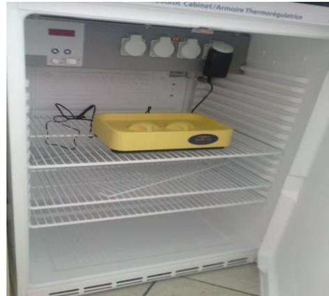
Figure 17 : Enceinte DBO mètre.
