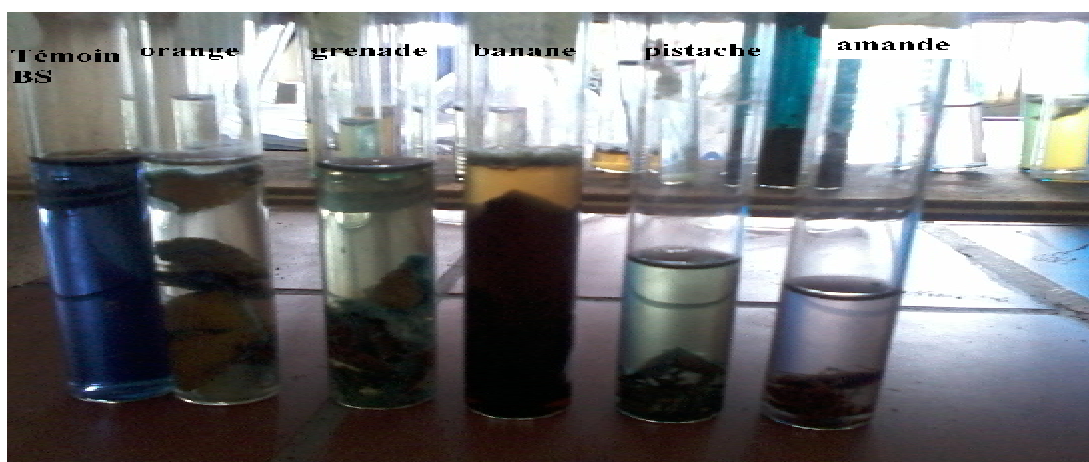
Figure V.4 : Testes préliminaires d'adsorption du colorants BS sur déchets biodégradables.
