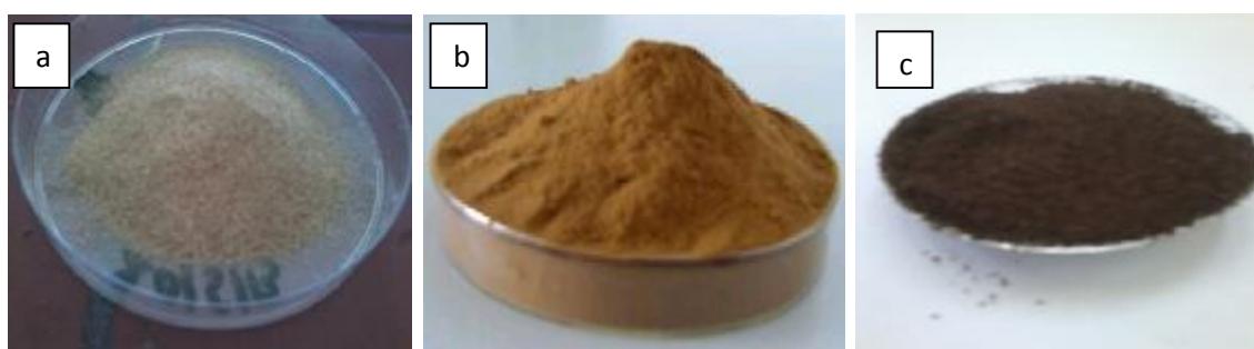
Figure V.6 : Poudre de matériaux sorbants testés (broyés et lavés) (a. écorces d'orange ; b. peau de grenade ; c. peau de banane).
