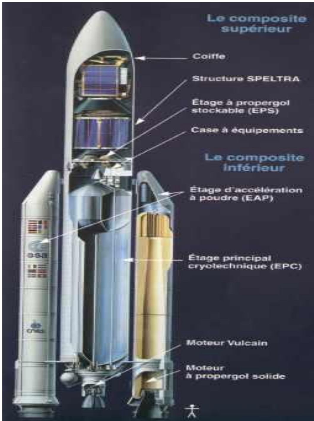
Figure I.1 : Les différents étages qui composent une fusée spatiale.
