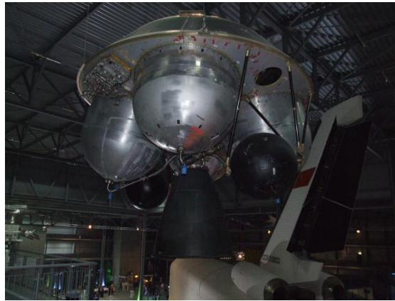
Figure I.4 : Etage à Propergols Stockable.
