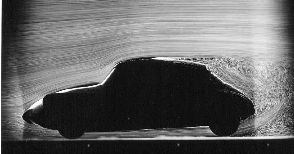
Figure II.5 : Maquette automobile dans une veine d'essai de soufflerie [3].
