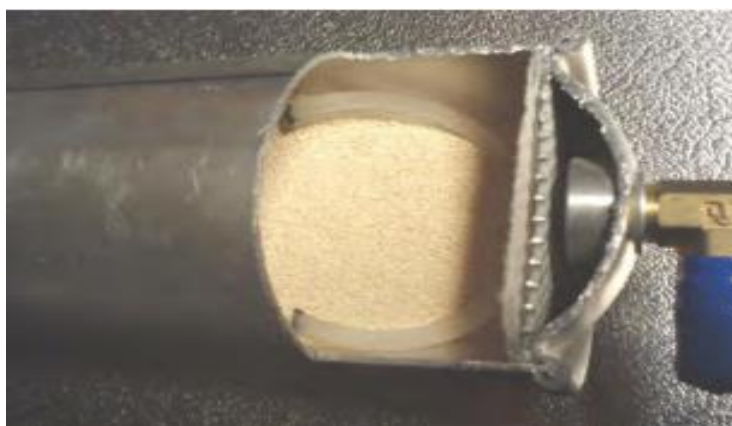
Figure (I - 17) : billes de zéolithe dans la colonne. [1]
