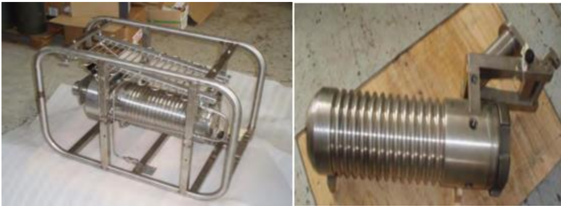
Figure (I - 8) : cadre acier du Soprano 3000 ® et la chambre de réaction. [1]
