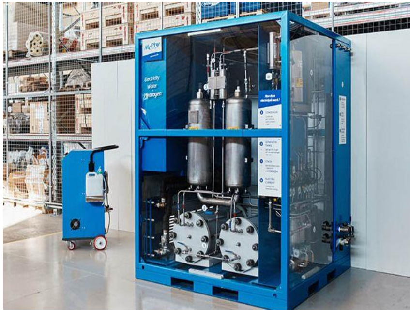
Figure (I - 13) : électrolyseurs - MCPHY (ITALIEN).
