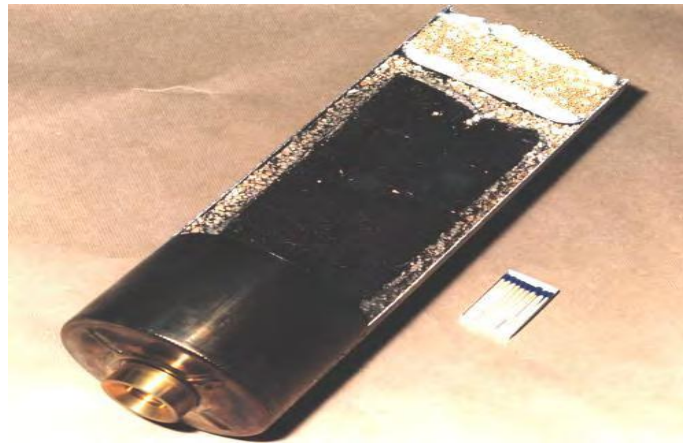
Figure (I - 5) : coupe d'une chandelle chimique Orphée®. [1]
