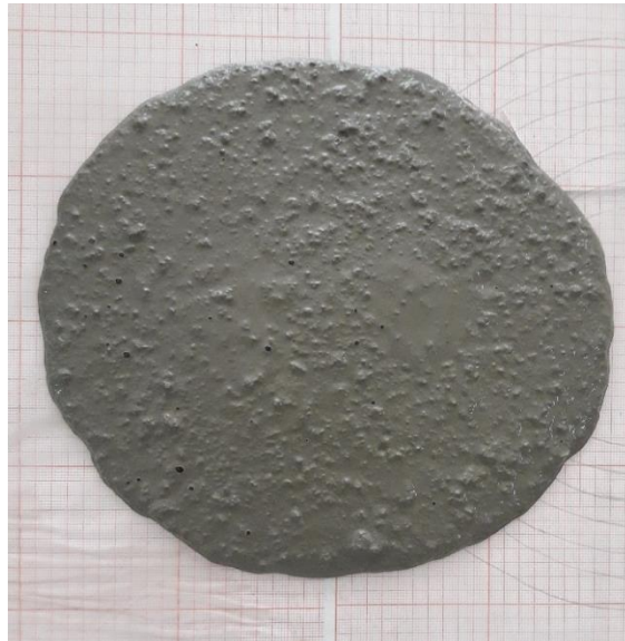
Figure V-28 : La galette obtenue après étalement: substitution du sable.
