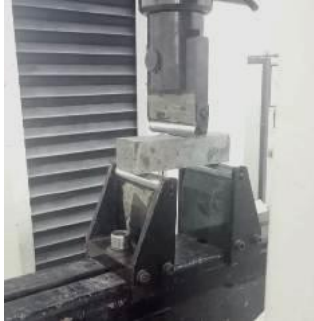
Figure V-11 : Epreuves prismatique soumis à la traction par flexion
