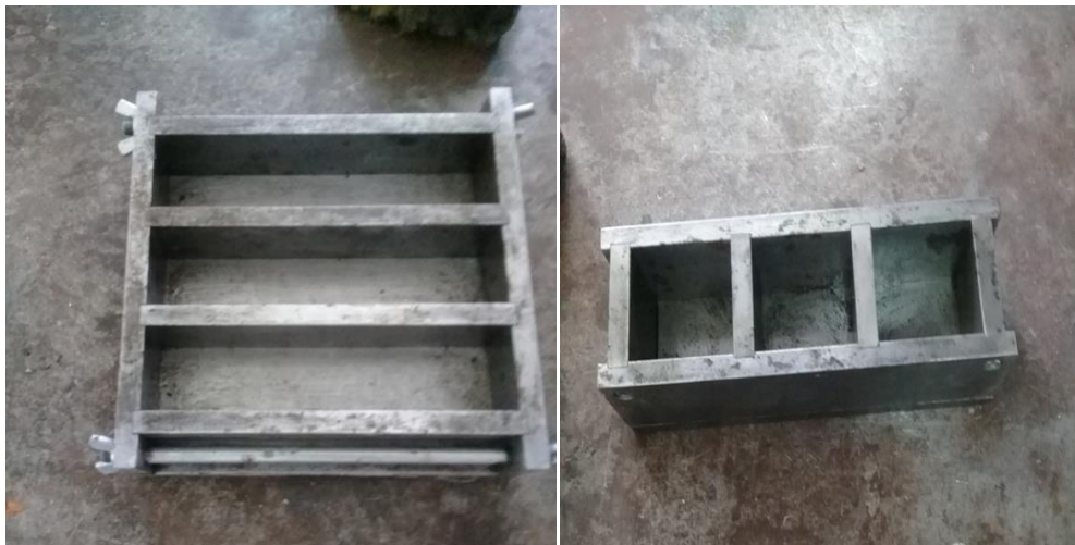
a) Moule prismatique ( 4 \times 4 \times 16 ) \text{cm}^3 b) Moule cubique ( 5 \times 5 \times 5 ) \text{cm}^3
