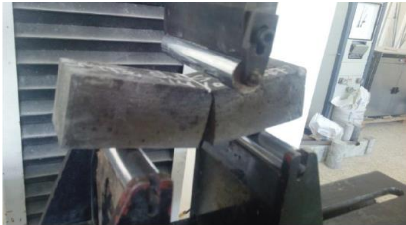
Figure V-22 : Etat de l'éprouvette après l'essai de flexion.
