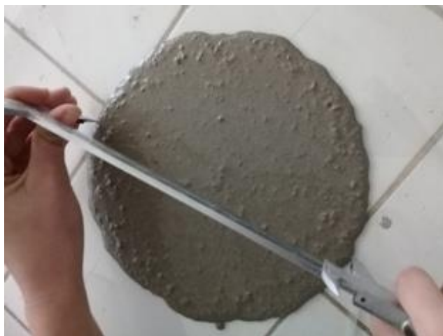
Figure V.13 : Essais d'étalement sur le mortier autoplaçant frais.
