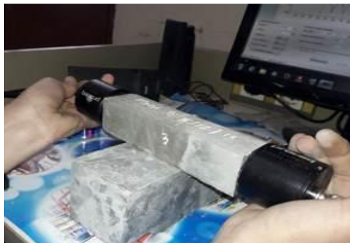
Figure V-12: Epreuves prismatique soumis à l'ultrason
