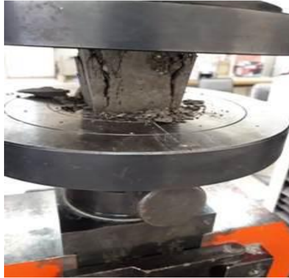
Figure V.17 : Etats de l'éprouvette après l'essai de compression
