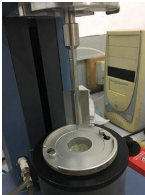
Figure V-8 : Conduite de l'essai rhéologique
