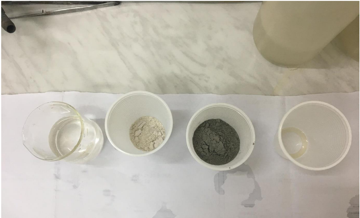
Figure V-6 : Echantillons préparés pour le 1 er essai rhéologique (Eau+Fillers+Ciment+SP)
