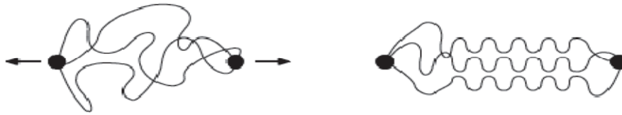
Figure. I.12 : Cristallisation sous contrainte [5].
