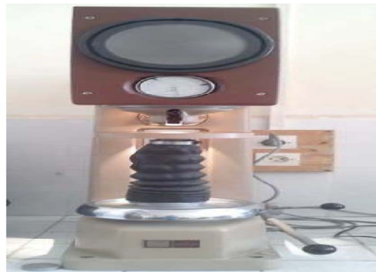
Figure III.15 : duromètres de type « WOPERT DIA TESTOR RC »
