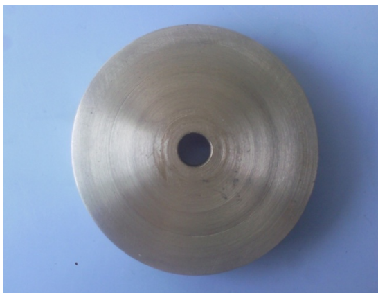
Le 1 er disque avec un état lisse d'une rugosité 2,18 micromètre
