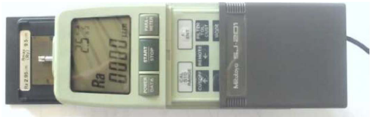
Figure III.16 : rugosimètre a palpeur
