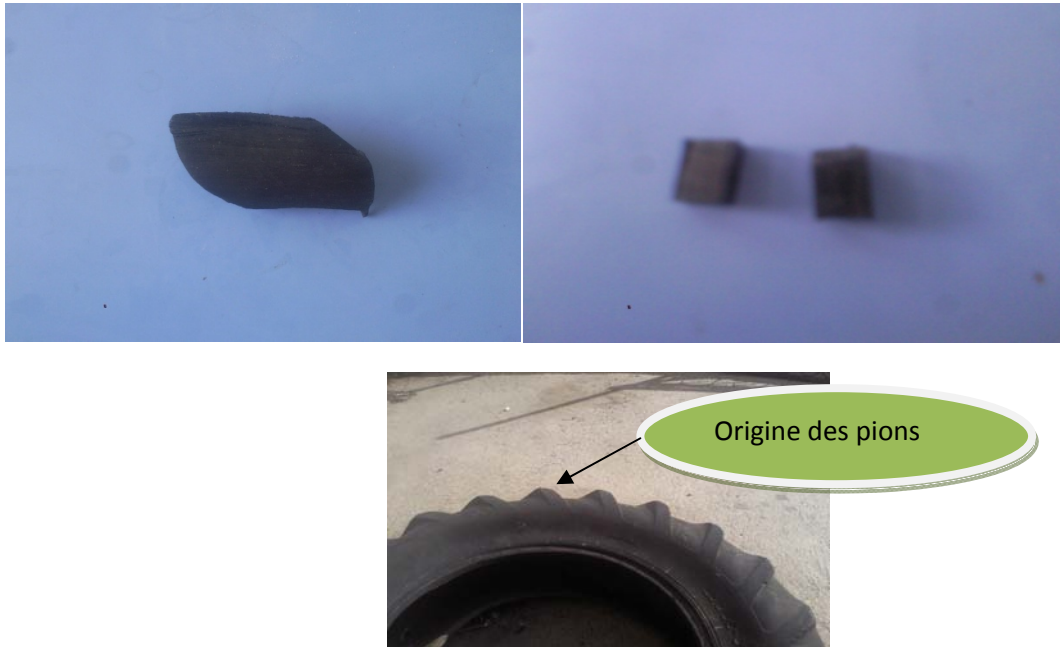
Figure III.8 l'origine et géométrie des pions
