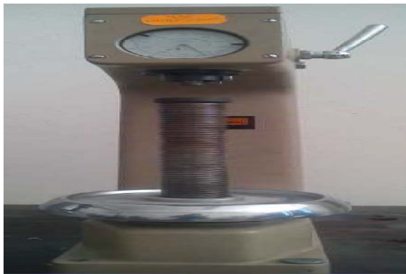
Figure III.15 : duromètres de type « WOPERT DIA TESTOR RC »
