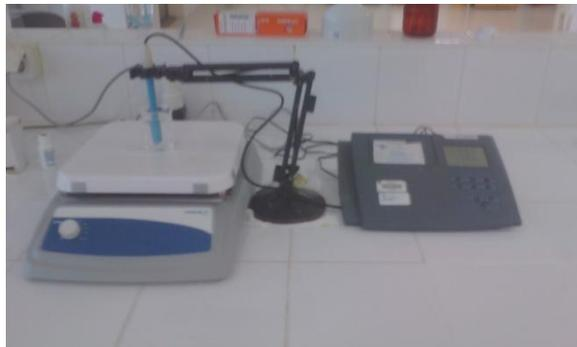
**Fig.11** pH-mètre et agitateur magnétique (Originale, 2017)
