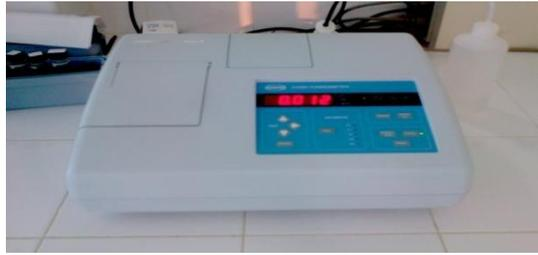
**Fig.12** Turbidimètre(Originale, 2017)
