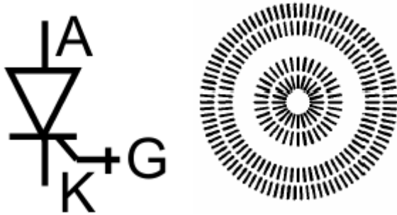
Figure I.8 : Symbole du thyristor GTO Figure I.9 : Inter-digitation des doigts decathode [ABB]
