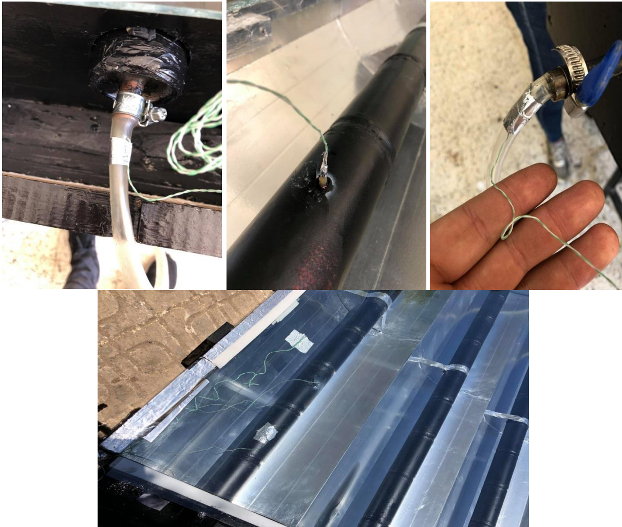
Fig.IV.20. Emplacement des thermocouples
