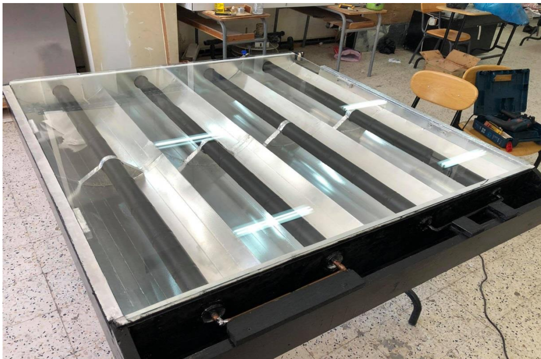
Fig.IV.15. Concentrateur fini avec vitre.
