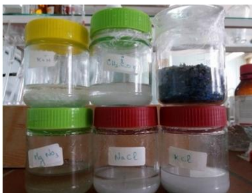
Figure (II.5) : solutions salines utilisés pour le capteur d'humidité
