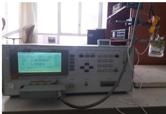
Figure (II.3) : Photographie de l'appareil de mesure des propriétés diélectriques.
