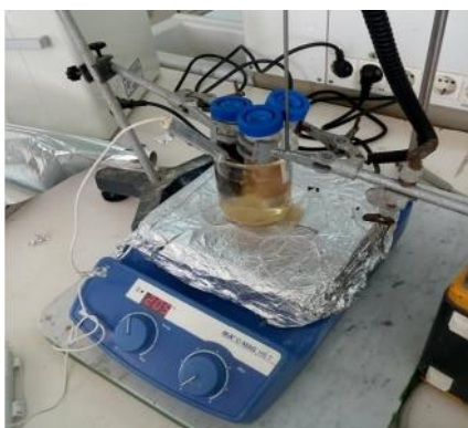
Figure (II.1): Synthèse des nanocomposites CSTZ-FC par le processus hydrothermale.
