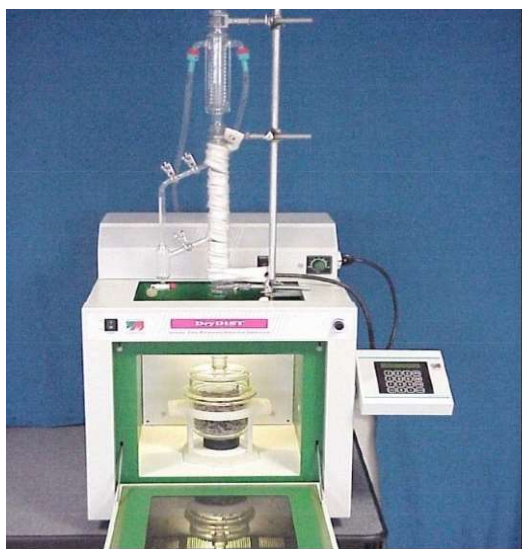
Figure 06 : Réacteur micro-ondes pour extractions assistées par micro-ondes [56]
