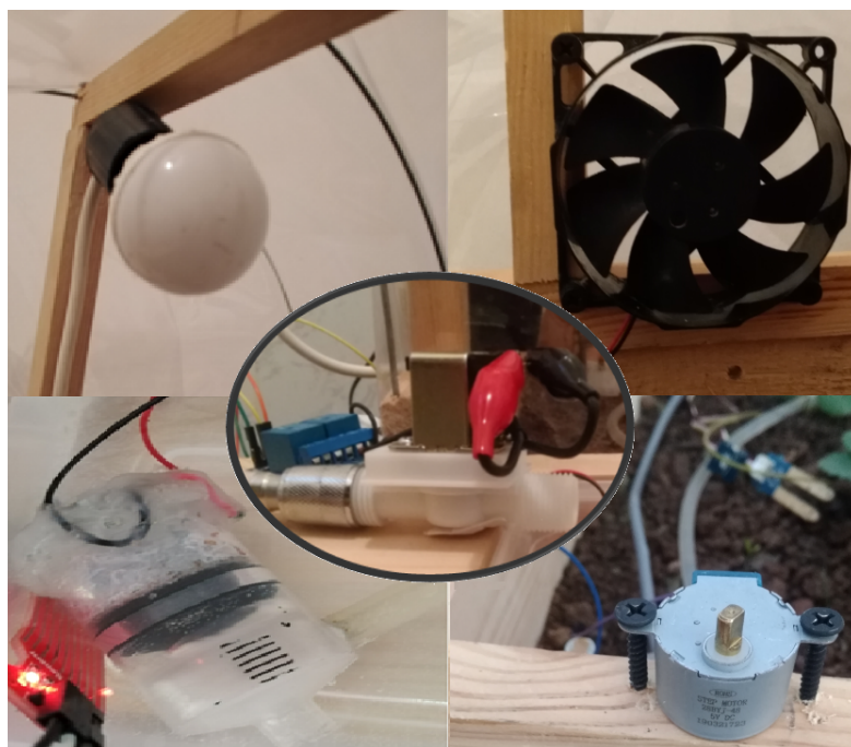
FIGURE 4.3 – Les actionneurs installés dans la serre
