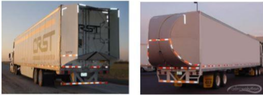
Fig. II. 17 : A gauche : Plaques longitudinales utilisées sur un poids lourd. A droite : Appendice amovible "Aerovolutionproduct" [9].
