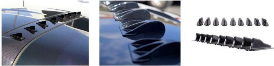
Fig. II. 8 : Exemple de contrôle passif par générateurs de vortex.
