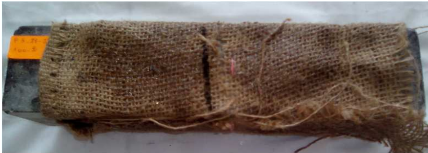
Figure III.3 : Rupture de l'éprouvette confinée avec RFJ.
