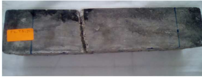
Figure III.9 : Rupture de l'éprouvette en béton témoin.
