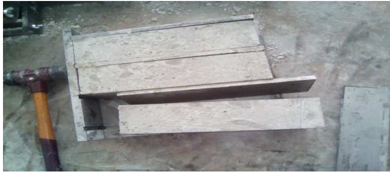
Figure II.13 : Démoulage des éprouvettes.
