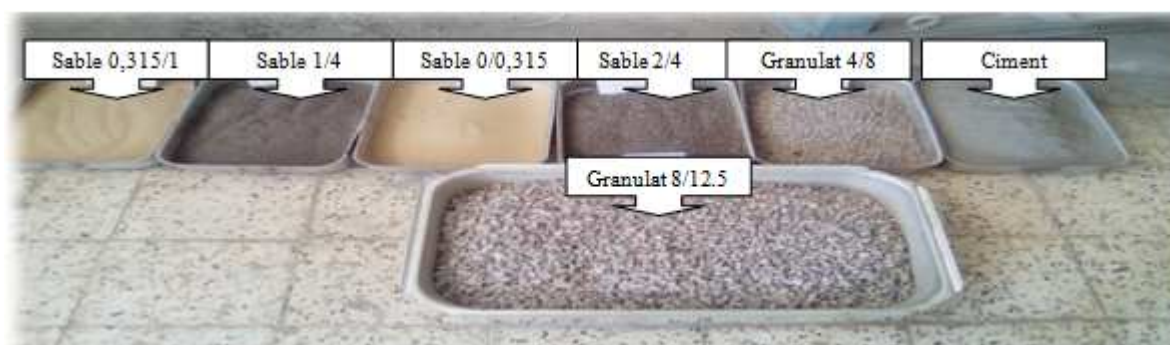
Figure II.8 : Les constituants du squelette granulaire.
