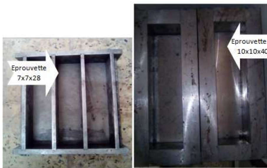
Figure II.9 : les deux types des moules utilisés.
