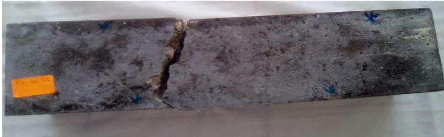
Figure III.13 : Rupture de l'éprouvette en béton témoin.
