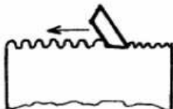
Figure II.12 : Schéma d'un arasement de dégrossissage et arasement terminal. [34]
