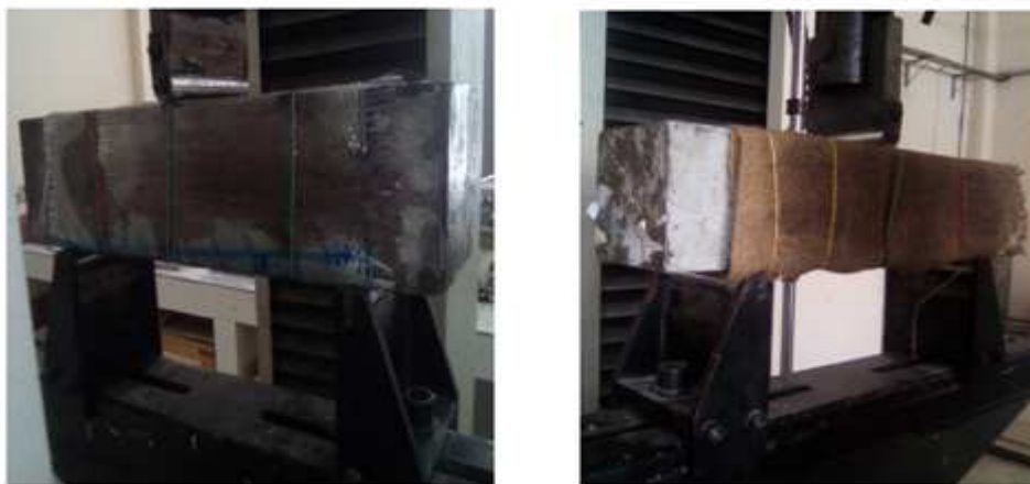
Figure II.19 : A-Essai de flexion 3 pts sur éprouvette confinée avec RFV, B-Essai de flexion 3 pts sur éprouvette confinée avec RFJ.
