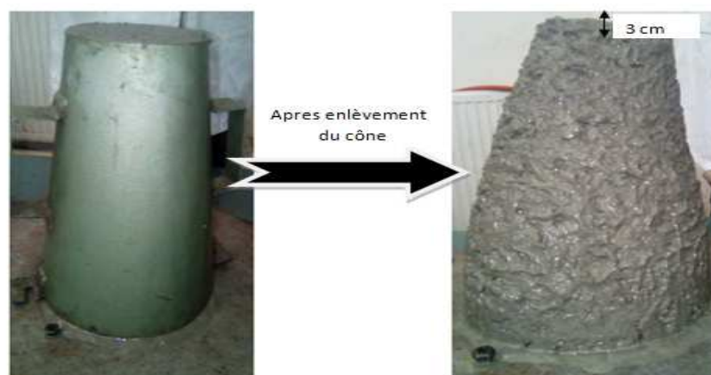
Figure II.10 : Les étapes l'essai d'affaissement au cône d'Abrams.
