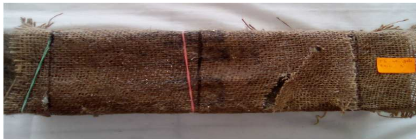
Figure III.15 : Rupture de l'éprouvette confinée avec RFV.
