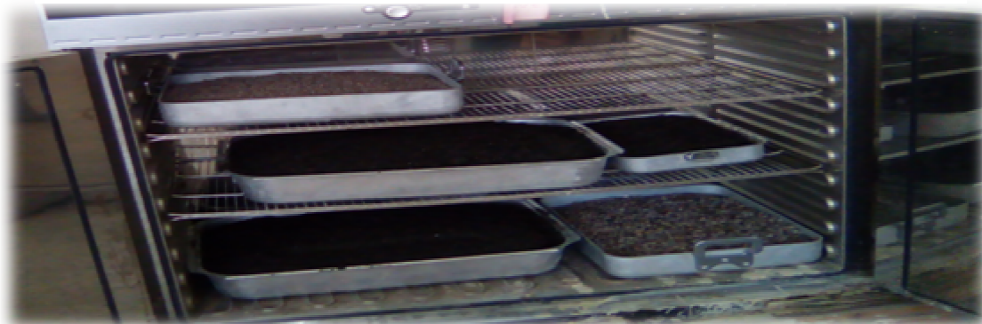
Figure II.7 : Séchage des granulats en étuve.
