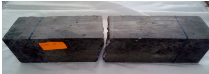
Figure III.1 : Rupture de l'éprouvette en béton témoin.
