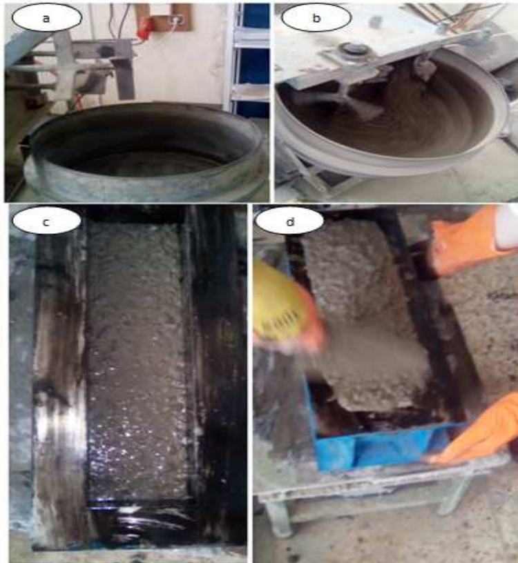
Figure II.11 : Confection du béton, compactage et vibration des éprouvettes.
