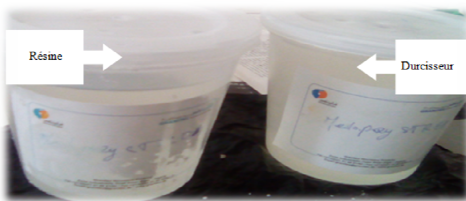
Figure II.5 : Les deux Composants de la matrice (durcisseur et résine).
