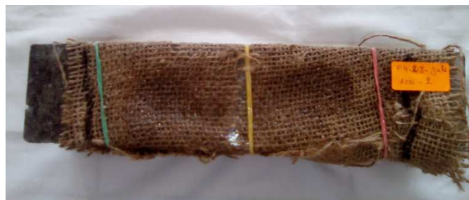
Figure III.11 : Rupture de l'éprouvette confinée avec RFJ.
