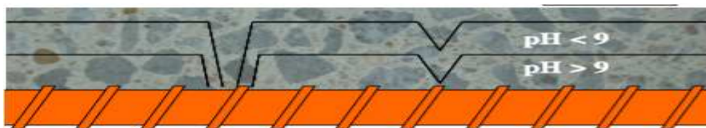
Figure I.1 : La carbonatation du béton [15]
