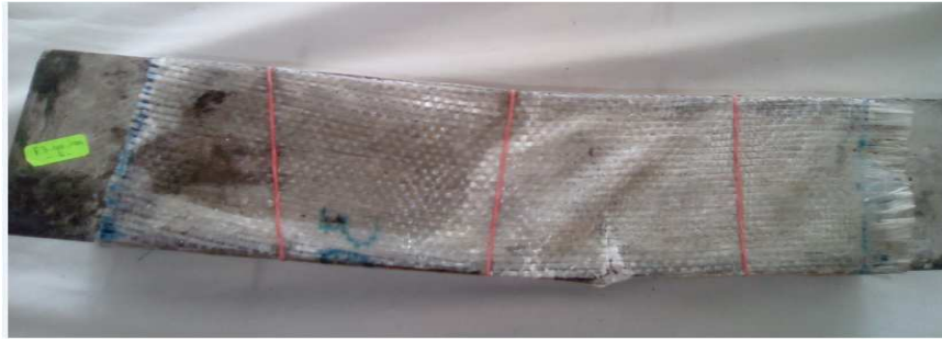
Figure III.6 : Rupture de l'éprouvette confinée avec RFV.
