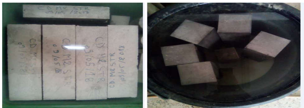
Figure II.14 : Cure d'hydratation des éprouvettes en béton.
