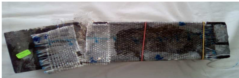
Figure III.14 : Rupture de l'éprouvette confinée avec RFV.
