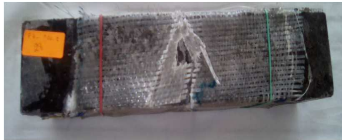
Figure III.10 : Rupture de l'éprouvette confinée avec RFV.
