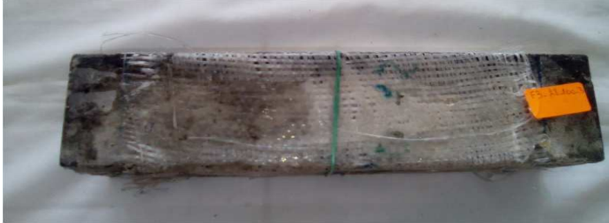
Figure III.2 : Rupture de l'éprouvette confinée avec RFV.
