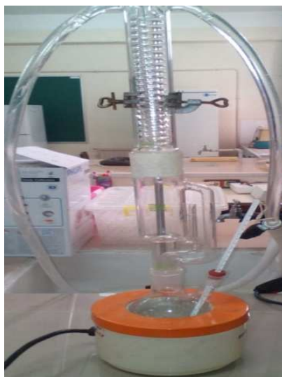
Figure 12: Montage de la réaction de solubilisation du chitosane dans l'acide acétique 2% à 95°C pendant 8heures
