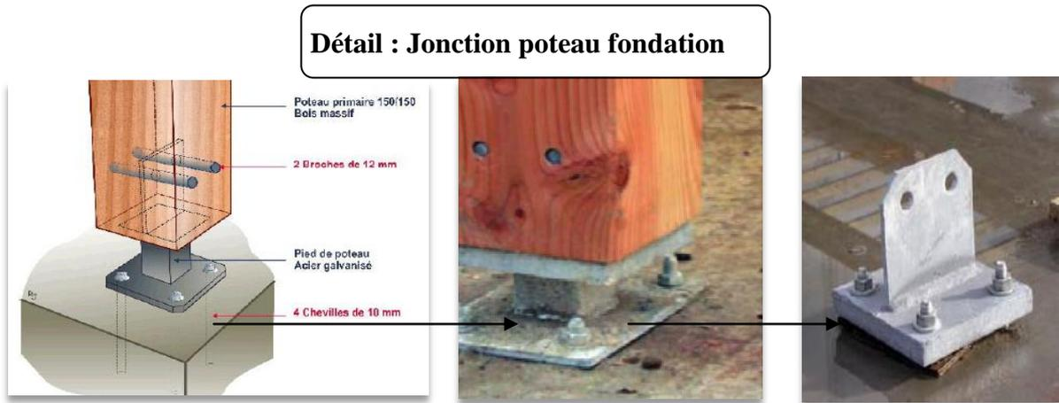
Figure98 : liaison poteau fondation avec sabot
