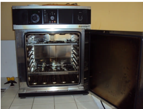
3 : Stérilisation à l'étuve
