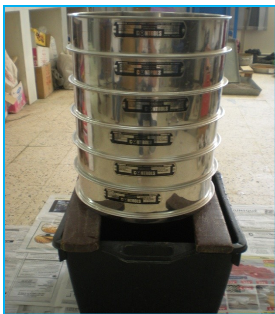
Figure 14: Disposition des tamis de maille 63 \mu m, 80 \mu m, 125 \mu m, 160 \mu m, 250 \mu m, 500 \mu m, respectivement l'un au –dessus de l'autre.
