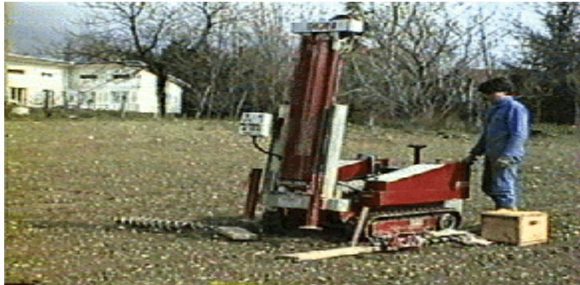
Figure II.2. Pénétrömètre statique.
