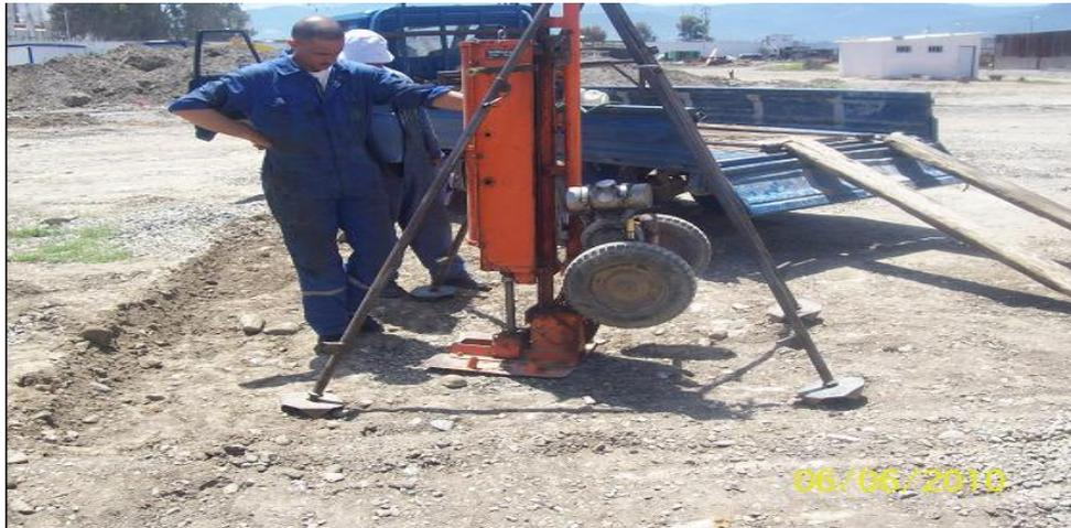
Figure II.4. L'essai de pénétration dynamique.
