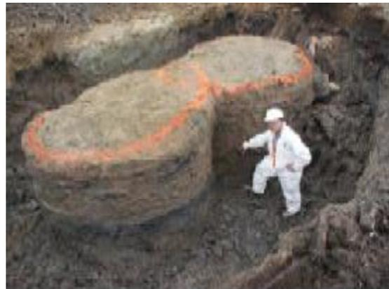
Figure I.19 : schéma illustrant les colonnes chevauchantes stabilisées de DSM.
