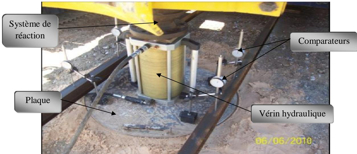
Figure V.3. Dispositif de l'essai de chargement.
