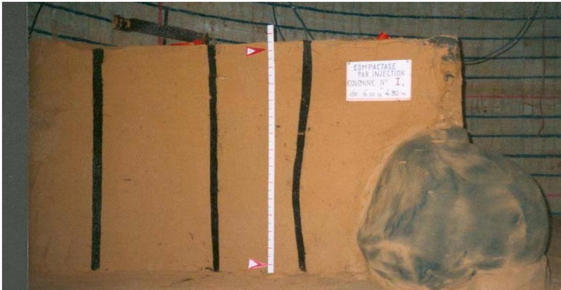
Figure I.5. Photo d'une boule de mortier injectée dans un massif de sable fin lâche (chantier CEBTP/photo C.P).
