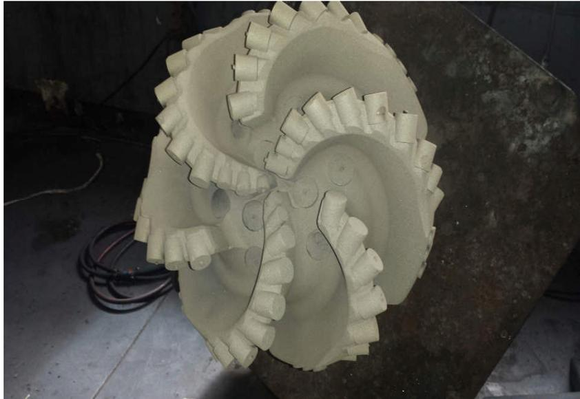
**Figure36 :**l'opération hardfacing
