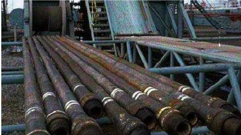
Figure 12 : Tiges de forage
