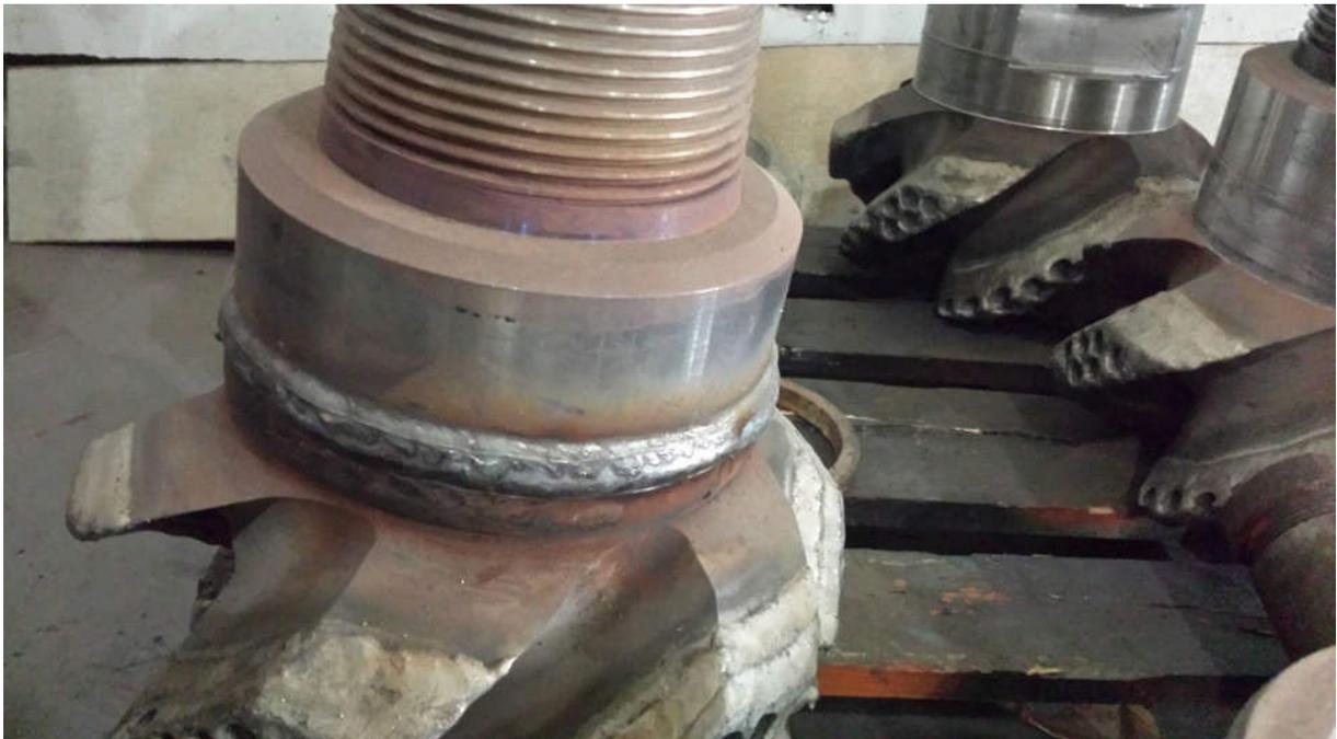
Figure 35 : soudage de bitshank avec la tête
