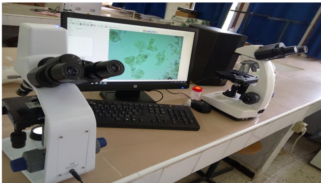
Figure 13 : Microscope optique « Optika vision lite 2.1 » relié à un ordinateur comportant le logiciel de mesure des œufs ( Original 2022 ).
