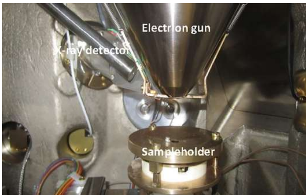
Figure. III.5: Photographie du dispositif expérimental utilisé pour les mesures de potentiel de surface dans les isolants.
