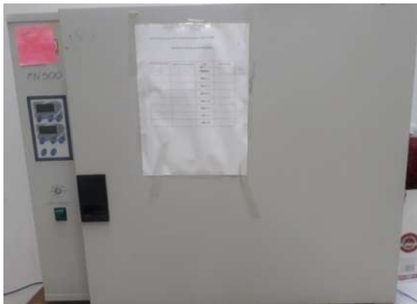
Figure III.2. Photographie de l'étuve de marque NUVE, type FN500 utilisée pour vieillissement thermique
