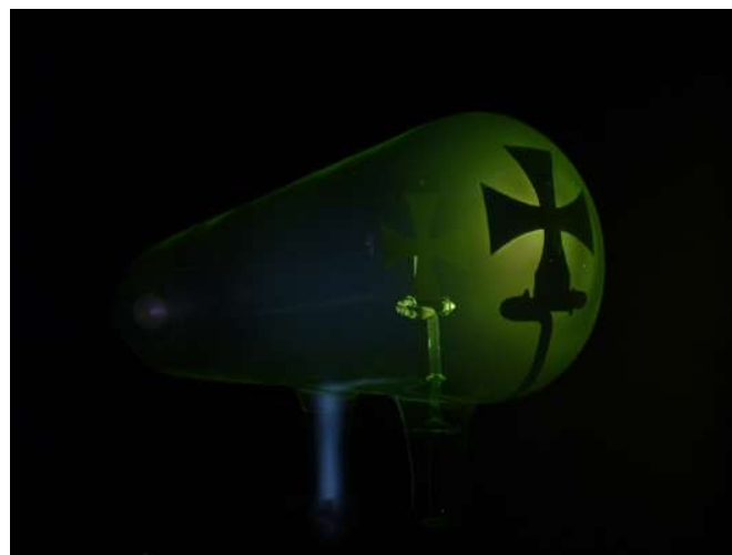
Fig. 1.3 Mise en évidence des rayons cathodiques.
