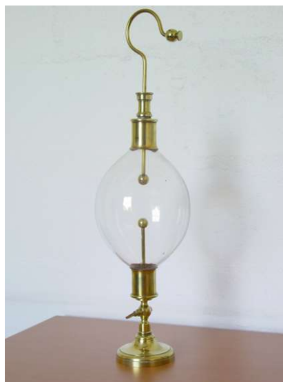
Fig. 1.1 Appareil de Faraday pour étudier les décharges électriques dans les gaz.
