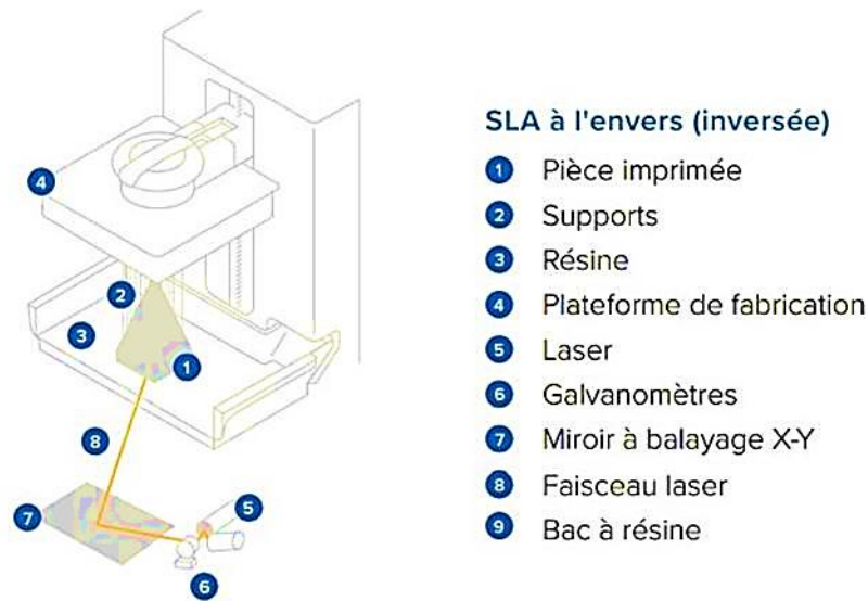
Figure 17 : Représentation graphique du fonctionnement de base de l'impression 3D SLA
