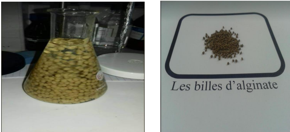
Figure IV.14: Préparation des billes alginate-bentonite.
