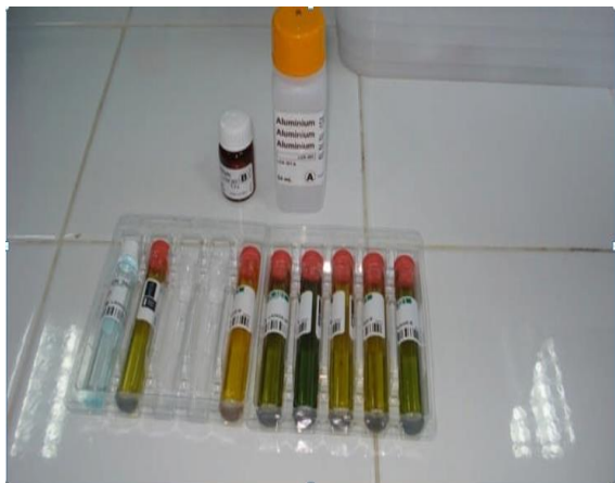
Figure IV.11: Tubes à LCK301 (réactif A et réactif B).
