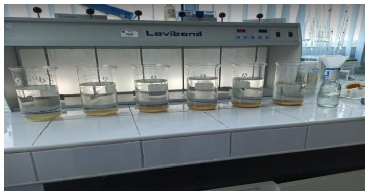
Figure IV.15: Détermination du temps de décantation optimal.
