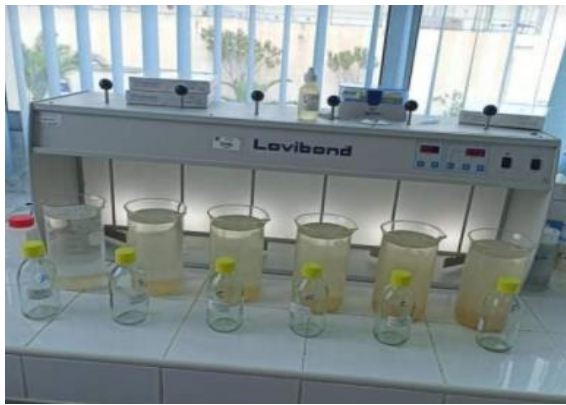
Figure IV.13: Détermination de la masse optimale du chitosane.
