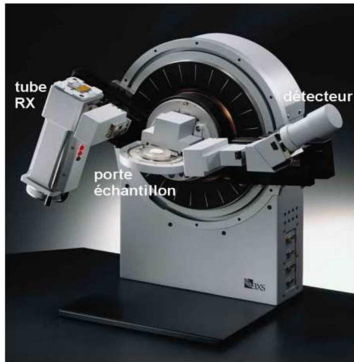
**Figure III.4 : Diffractomètre des rayons X**
