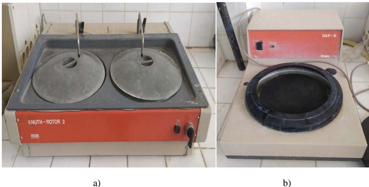
Figure III.11 a) polisseuse mécanique avec papier abrasif b) polisseuse de finition avec feutre imbibé d'eau contenant de l'alumine.
