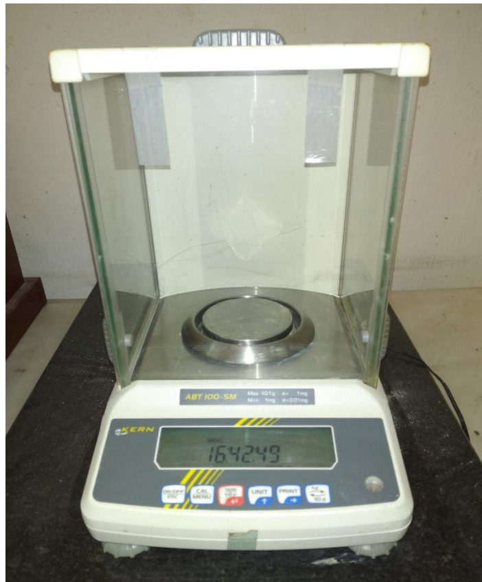
Figure III.2 Balance (KERN) ABT 100-5M avec une précision de 0,01mg.
