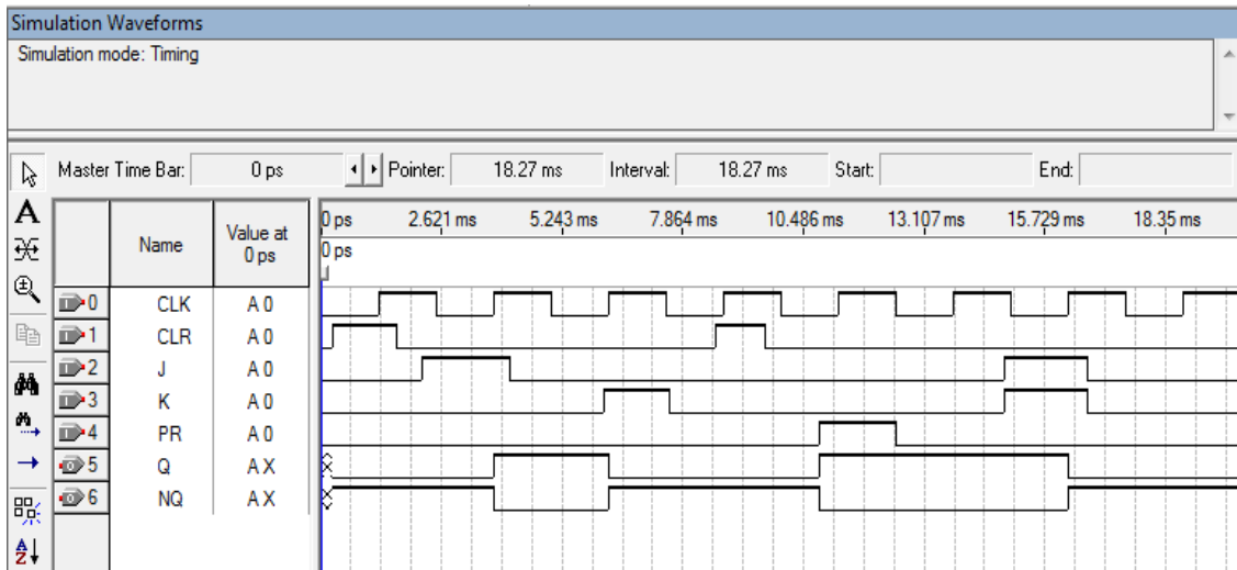
Figure IV-6 : Simulation du fonctionnement de la bascule JK.
